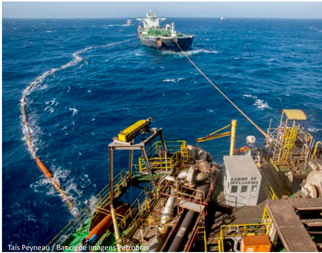
Figura 4 - Exemplo de operação de transferência de petróleo ( offloading )
