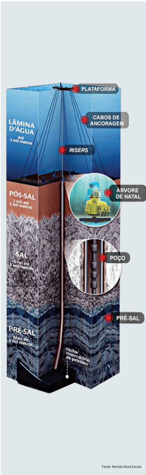
Figura 3 – Detalhe da interligação dos poços ao FPSO
